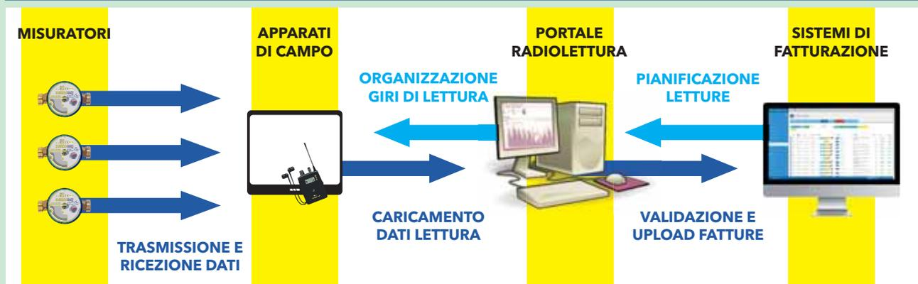
L'immagine mostra lo schema architetturale dell'infrastruttura per la radiolettura. Gli apparati radio installati sui contatori inviano messaggi con la lettura corrente a intervalli di 8 secondi. Gli operatori ricevono automaticamente le letture al loro passaggio, attraverso i dispositivi di cui sono dotati. I giri di lettura sono organizzati, caricati e verificati attraverso un portale dedicato che comunica con i sistemi di fatturazione.
