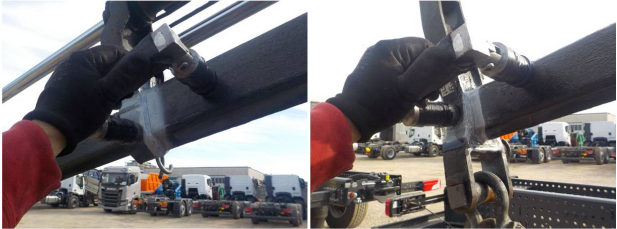
Figura 12: sfilì del braccio durante l'analisi MT
