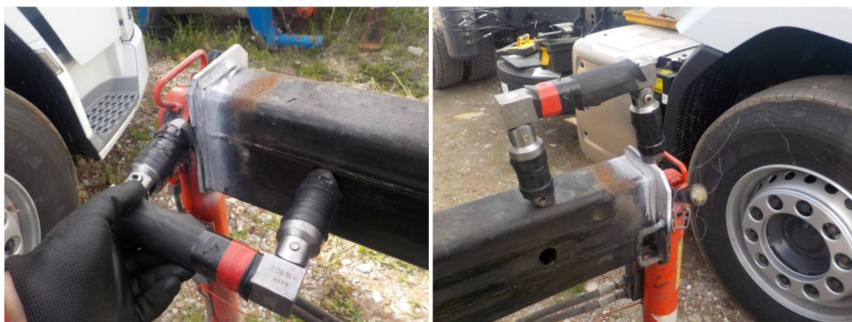
Figura 7: traverse e stabilizzatori durante l'analisi MT
