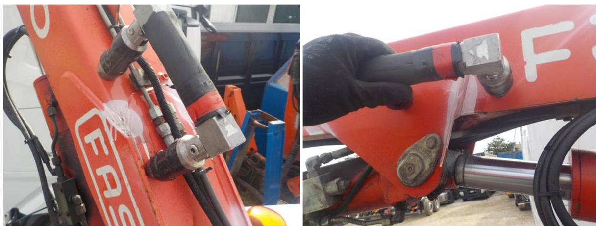
Figura 10: I° elemento di braccio durante l'analisi MT
