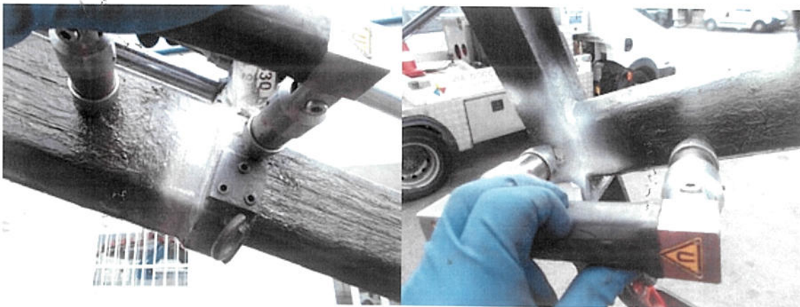
Figura 11: stili del braccio durante l'analisi MT
