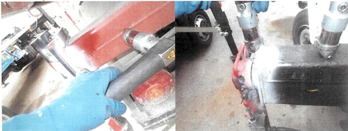
Figura 7: traverse e stabilizzatori durante l'analisi MT
