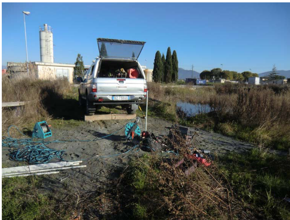
DHS1 – Panoramica del sito di indagine durante le acquisizioni con le onde SH e dispositivo utilizzato per generare le onde di taglio SH (traversina di legno con sovraccarico e percossa alle estremità).
