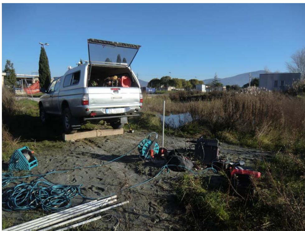
DHS1 - Strumentazione utilizzata per l'acquisizione del segnale sismico: simografo Geometrics Stratavisor NZXP a 48 canali, geofono da pozzo e tubo guida per la regolazione della direzione delle due terne in profondità.
